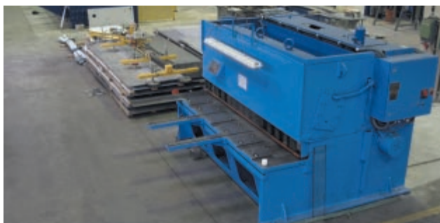
Scheren bis zu 6 m Länge und 20 mm Dicke Shearing up to 6 m length and 20 mm thickness
