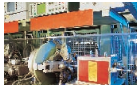
Automatische Prüflinie für Wirbelstrom- und Ultraschallprüfungen Automatic eddy current and ultrasonic testing unit
