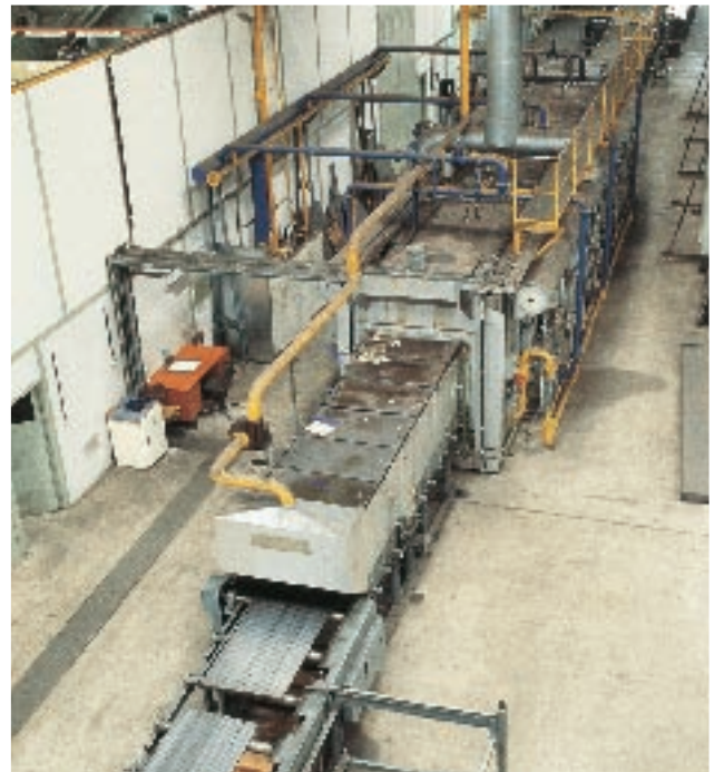
Durchlaufofen mit Schutzgasatmosphäre Continuous furnace with controlled atmosphere
