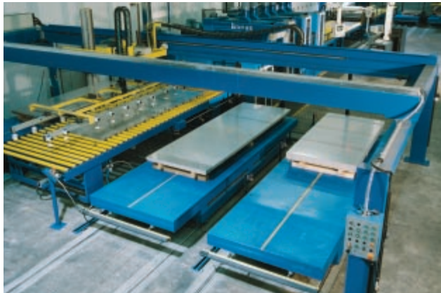
Schleif-/Bürst- und Folieranlage Grinding-/Brushing- and Foiling Line
