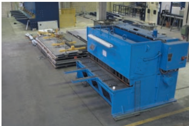
Scheren bis zu 6 m Länge und 20 mm Dicke Shearing up to 6 m length and 20 mm thickness
