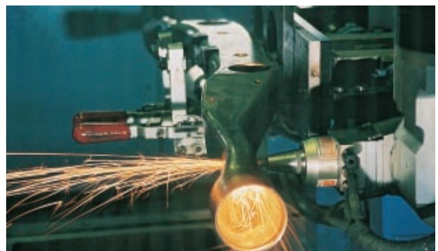
3D-Laserbeschnitt von Konturen und Enden – hochpräzise und genau durch CO 2 -Laserbearbeitungsmaschine 3d laser cutting of contours and ends - highly precise and exact by means of Co2 laser machining
