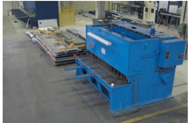
Scheren bis zu 6 m Länge und 20 mm Dicke Shearing up to 6 m length and 20 mm thickness
